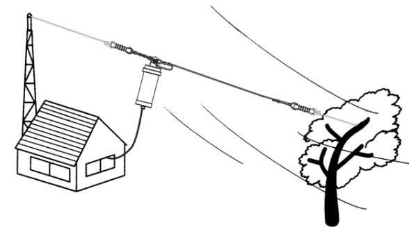
③給電部本体下部に同軸ケーブルを接続したのち、防水のためコネクター部には付属の自己融着テープを元の長さの約1.5倍程度に引き伸ばしながら巻き、さらにその上からビニールテープを巻いてください。
